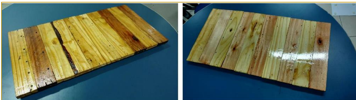
Figura 4: Painéis confeccionados com acabamento rústico (A) e uniforme (B) a partir do reuso de madeira de pallets
