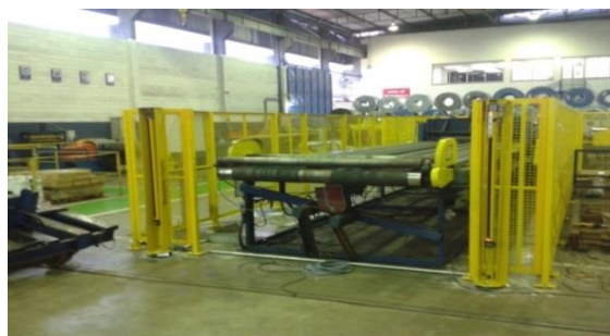
Figura 3: Cortina de luz com o emissor e receptor de feixe de luz
