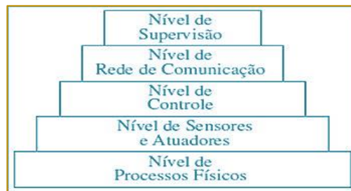
Figura 4: Níveis da Automação Implantada no BCS
