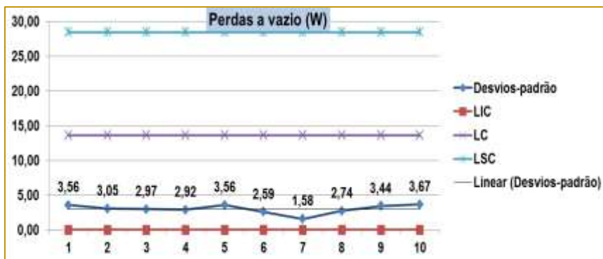
Figura 7 – Gráfico S para as medias dos desvios-padrão de um lote com dez unidades
