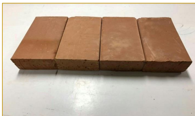
Figura 4: Tijolos obtidos da produção na indústria de cerâmica após adição do LETA
