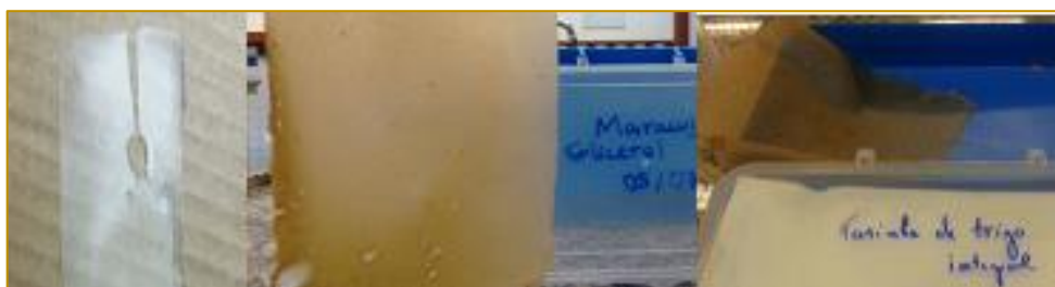
Figura 1 – Bioplásticos feitos a partir de fécula de batata/farinha de maracujá/farinha de trigo integral e glicerol
