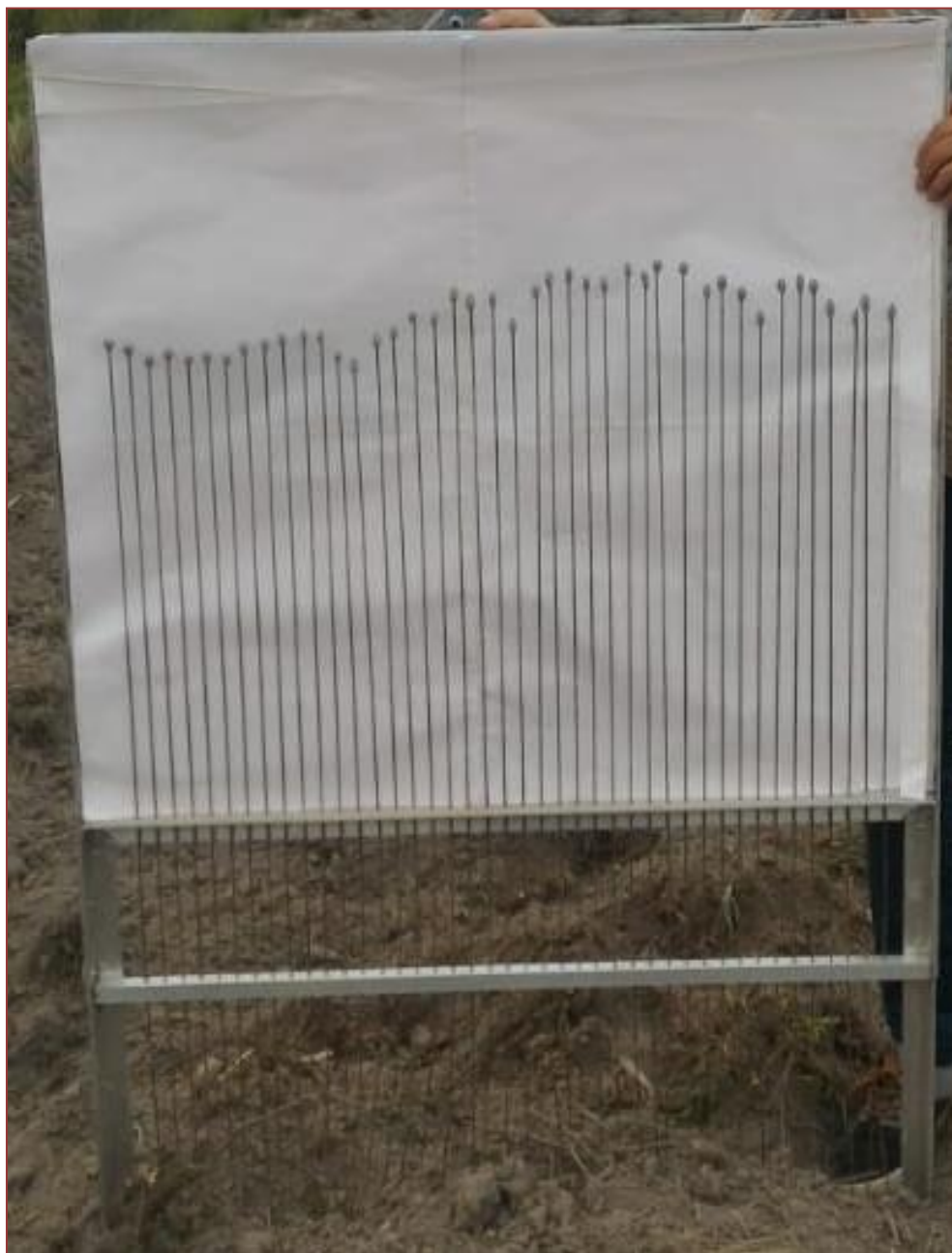
Figura 3. Perfilômetro de hastes construído para o experimento
