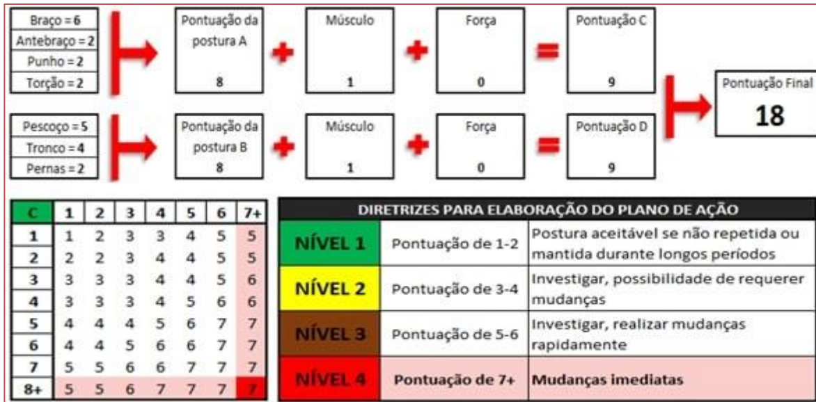
Figura 7: Determinação da pontuação final pela combinação das pontuações C e D, e classificação do nível de ação.
