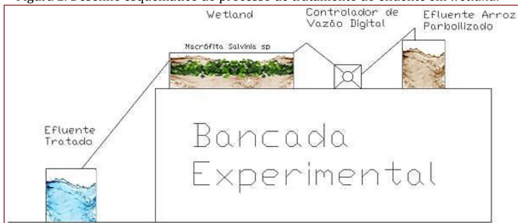
Figura 2. Desenho esquemático do processo de tratamento do efluente em wetland .
