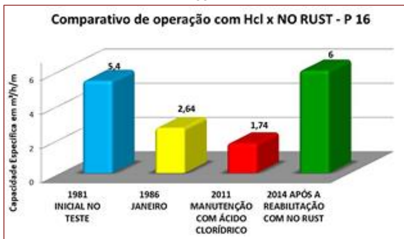
Fig. 04. Vazão comparativa antes e após as operações de desincrustação - P 16 com ácido clorídrico X NO RUST.
