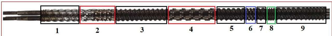
Figura 1. Configuração da rosca: (1,3,5,7,9) elementos de condução (transporte); (2,4,6) elementos de malaxagem (distribuição e dispersão); (8) elementos de turbina (dispersão).
