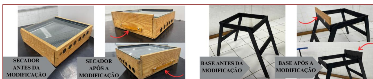
Figura 4. Modificações realizadas no protótipo original. [7]
