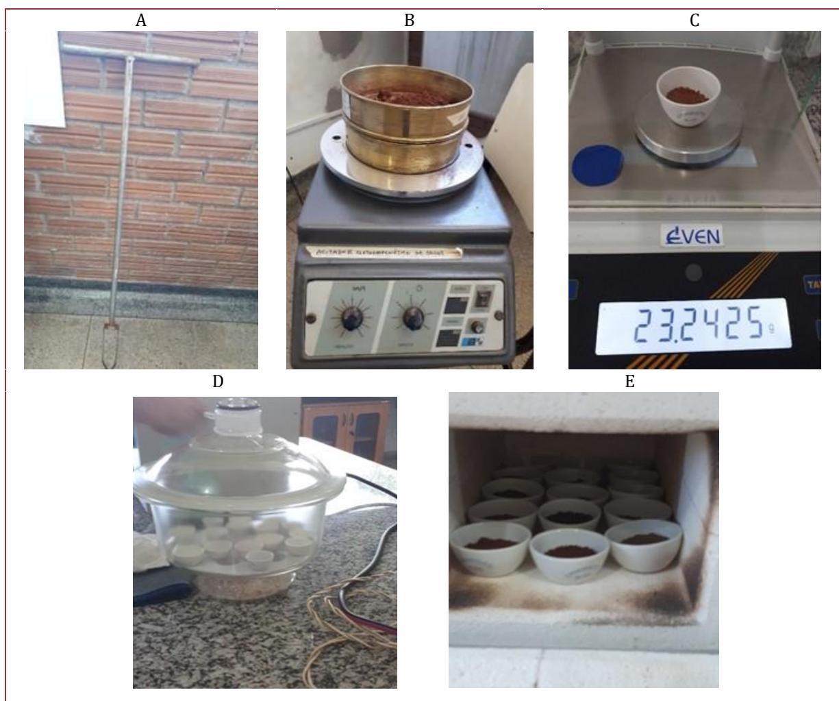
Figura 1. Materiais utilizados na pesquisa: (A) trado coletor. (B) agitador eletromagnético. (C) balança de precisão. (D) dessecador. (E) forno mufla
