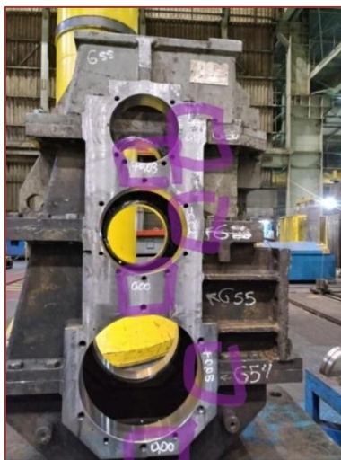
Figura 4 – Carcaça recuperada pelo novo método de trabalho
