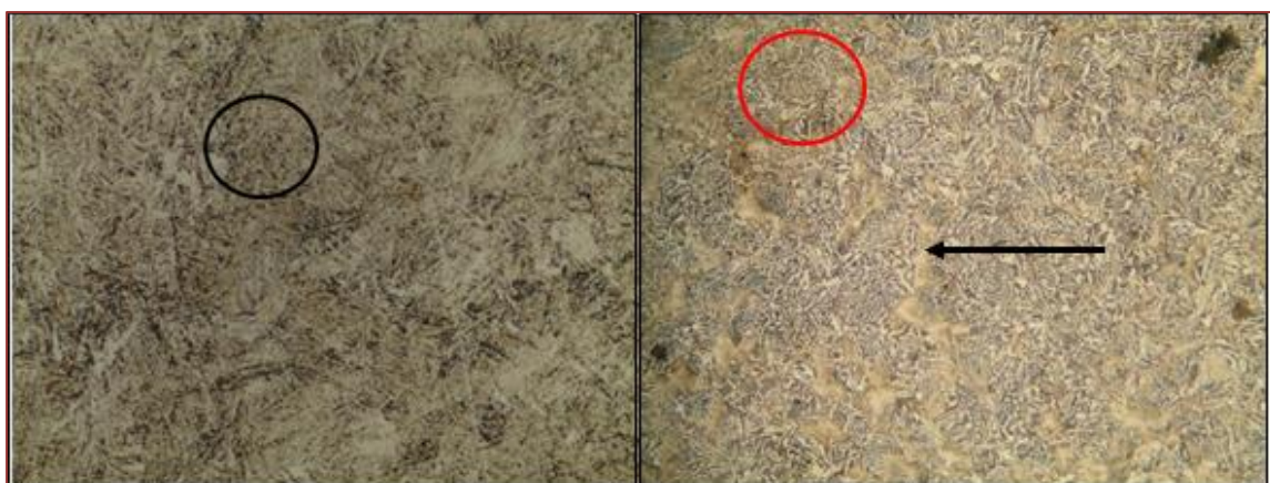
Figura 5 - Microestrutura dos corpos de prova com aumento de 500x: a) Novo; b) Fraturado.
