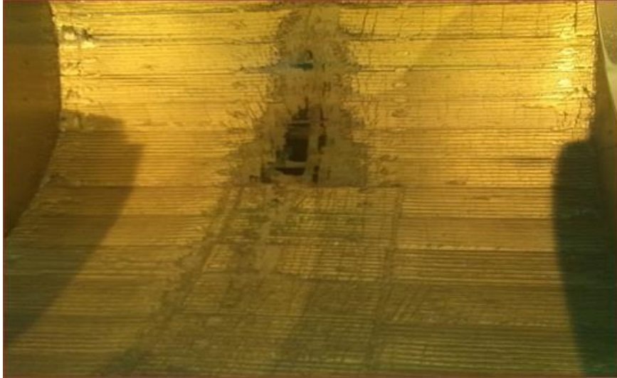
Figura 4 - Desgaste da carcaça.
