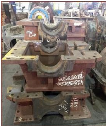
Figura 1 - Carcaça após ser enchida de solda.
