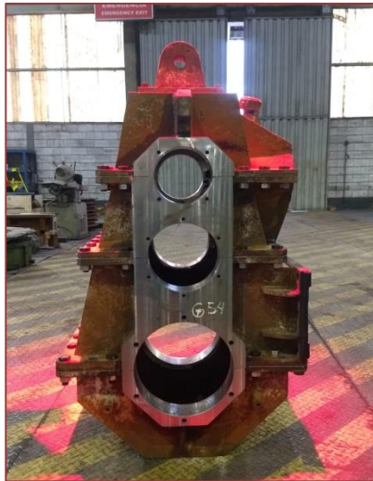
Figura 3 – Carcaça com a recuperação
