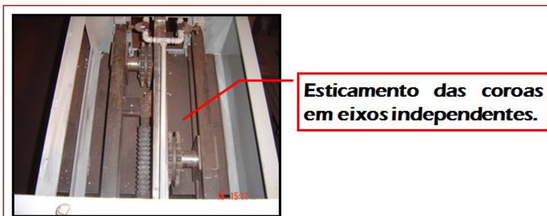
Figura 6 - Coroas em Eixos Independentes
