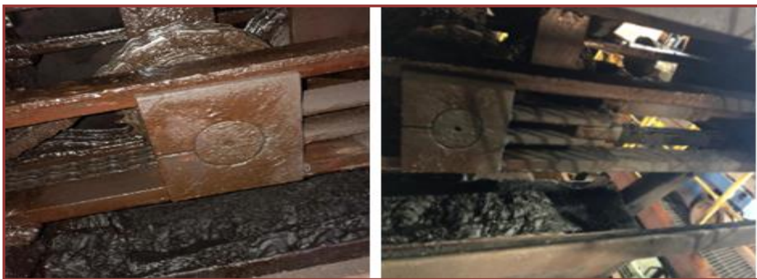
Figura 5 - Sistema de esticamento de correntes com a folga da corrente
