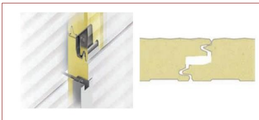
Figura 4 – Detalhe de montagem e detalhe de encaixe dos painéis termowall
