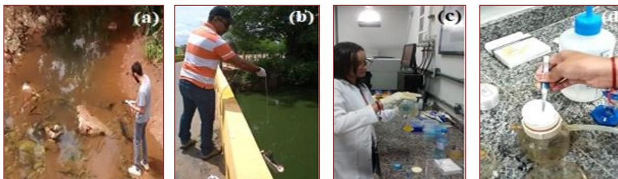
Para a realização do teste de  $DBO_5$  (Demanda Bioquímica de Oxigênio) primeiramente as amostras de água coletadas foram analisadas no momento imediato a chegada ao laboratório. As amostras e o branco (água de diluição) foram incubados a  $20^{\circ}C$  por 5 dias (Cunha et al., 2012).
